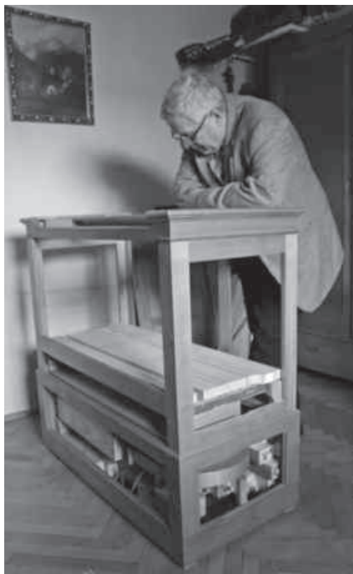
Der Orgelbauer Hermann Binder am Gehäuse des Orgelpositivs. Im unteren Bereich ist ein Teil des Gebläsemotors zu sehen und einige querliegende Holzpfefen.
